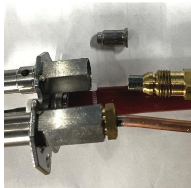
Figure 10.3 – Nettoyage de l'orifice de la veilleuse
