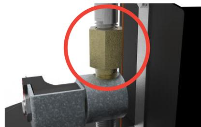
Figure 9.1 – Localisation de l'orifice pour le nettoyage.
