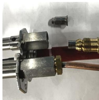
Figure 9.3 - Nettoyage orifice pilote.
