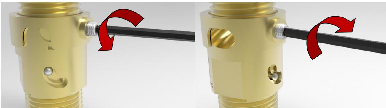
2. Sur la face avant de l'orifice, utilisez un tournevis à tête plate #2 pour faire pivoter l'orifice de NG à LP ou LP à NG en fonction du type de gaz approprié. Assurez-vous toujours que les couleurs de l'orifice et du collier sont alignées.
