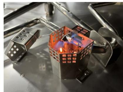
Figure 9.2 - Couverture de la flamme pilote du thermocouple.
