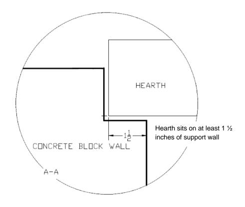
HEARTH RESTS ON NOTCH IN CONCRETE BLOCK WALL
